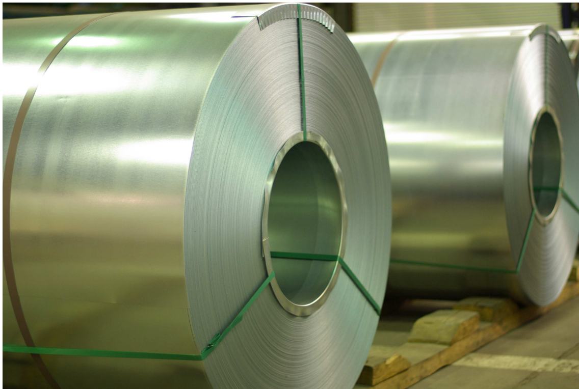
KRĄG OCYNKOWANY OCZEKUJĄCY NA ZAPAKOWANIE
